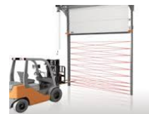
Rys. Kurtyna świetlna zabezpiecza światło wjazdu, nie zastąpiona w bramach wyposażonych w drzwi serwisowe z obniżonym progrem
